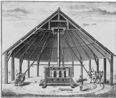
(Izquierda) Molino de tres rodillos movido por caballos. Brasil, siglo XVIII. Diderot y D'Alembert, Enciclopedia , 1762. (Derecha) Molino de tres rodillos movido por fuerza hidráulica. La imagen corresponde a comienzos del siglo XVIII. El fundamento de su funcionamiento se introduce hacia 1610. Labat, Nouveau voyage aux Iles de l'Amerique , 1742
