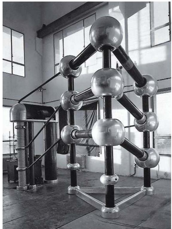
**acelerador electrostático.** *Nucl.* Acelerador en el que las partículas se aceleran al atravesar la diferencia de potencial creada por un generador electrostático. (ingl.: *electrostatic accelerator*).
